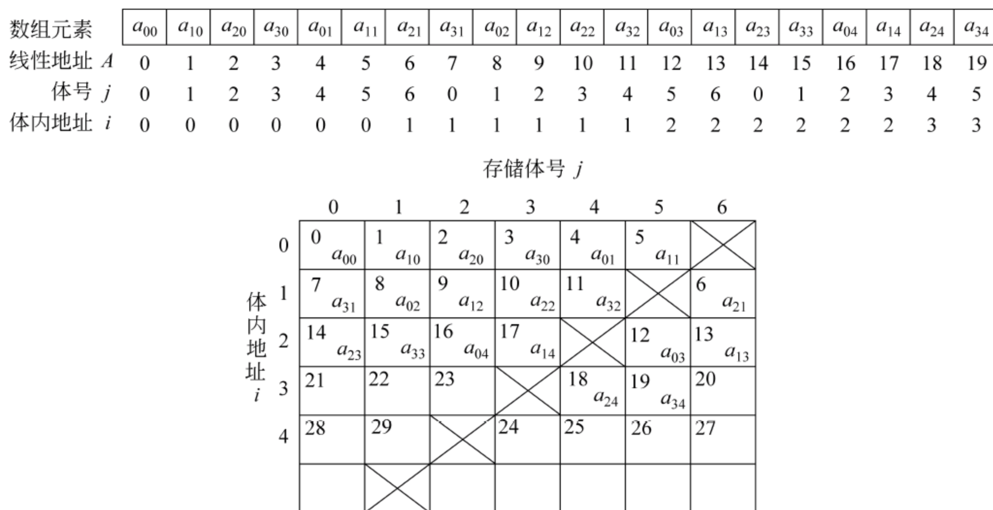
图 13.8 4 \times 5 二维数组在 BSP 并行存储器中的存储示意图( M=7, N=6 )
